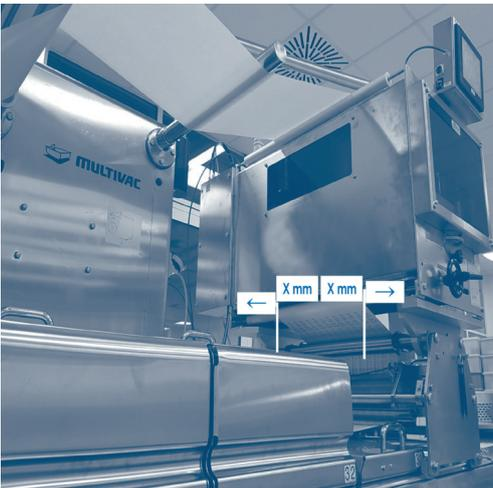
Den Drucker in die Mitte der Verpackungsmaschine stellen, damit die Folienmitte möglichst mittig zu den Druckköpfe läuft.
