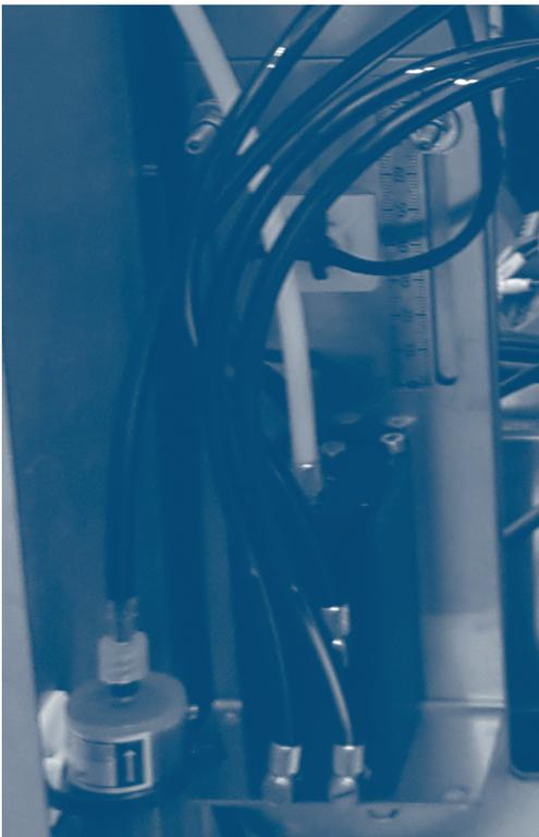
Für den Zugriff auf die Tintentanks die Schutzgehäuse des Hydraulikkastens (Abbildung 3.2.7, Nr. 5 und 7) mit Inbusschlüssel Ø 3mm entfernen. Um den Verlust von Tinte während des Transports zu vermeiden, wird die Position der Tanks vollständig abgesenkt und somit Unterdruck erzeugt (Sog). Vor der Inbetriebnahme müssen die Stützplatten auf maximaler Höhe positioniert werden.
