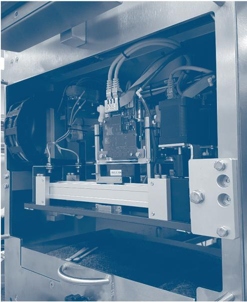
Um den einwandfreien Zustand der empfindlichsten Komponenten aufrechtzuerhalten, wird die Platte der Druckköpfe befestigt. Die Schelle zur Befestigung des Druckkopfs vor der ersten Inbetriebnahme entfernen.
