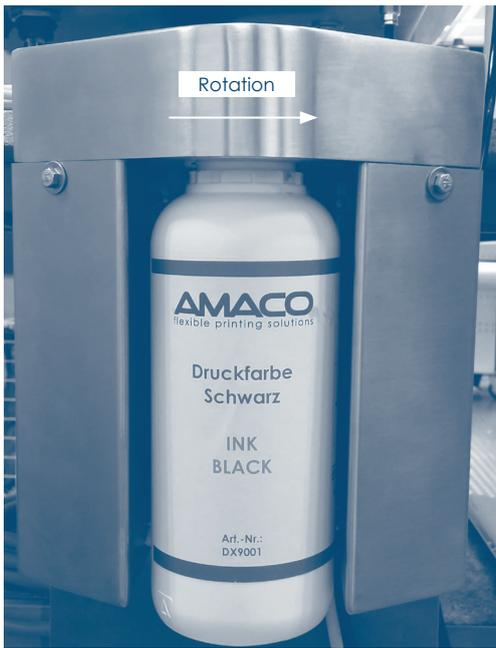
Die Flasche in der korrekten Drehrichtung lösen und den Warmschrumpfschlauch an der Nadel auswechseln: Darauf achten, denn einige Tropfen der im Schlauch enthaltenen Tinte könnten eventuell austreten. Dieses Verfahren sollte mit der Hilfe einer zweiten Person durchgeführt werden, die die Nadel abdichtet, sobald der Schrumpfschlauch entfernt wird.
